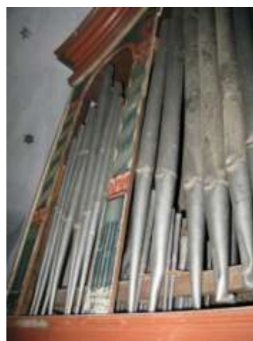
Corrosion du cuivre et altération mécanique (chocs) des tuyaux d'orgue/ Ph. N. Favergeon
