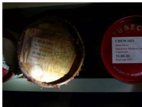
L'HR à 75,50 % entraîne l'oxydation active du couvercle en métal avec des perles de rouille (exsudation). Ph. MDP
